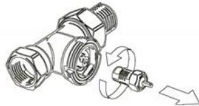
Alten Fühler entfernen, Anlage entleeren und die Ventilstopfbuchse herausdrehen.
