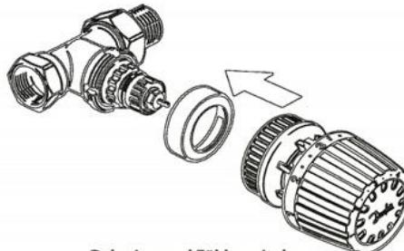
Dekoring und Fühler mit dem montagefreundlichen Schnappanschluss montieren. Fertig.
