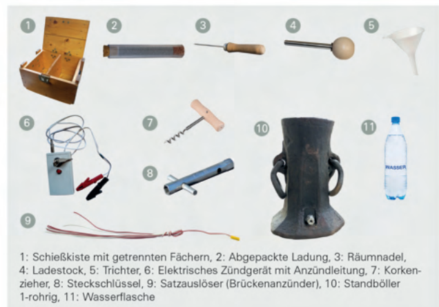
Abb. 51: Einrohriger Standböller mit elektrischer Anzündvorrichtung, Zubehör
