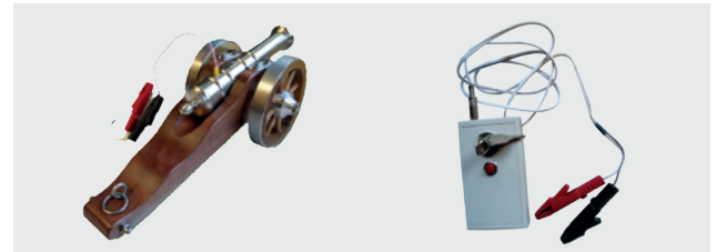
Abb. 17: Vorderladerkanone mit elektrischer Anzündung und batteriebetriebener Anzündvorrichtung
