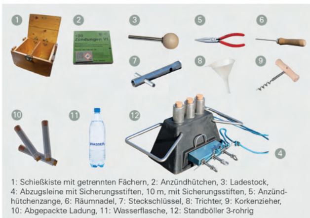
Abb. 46: Mehrrohriger Standbölller mit mechanischer Anzündung (Sirius), Zubehör
